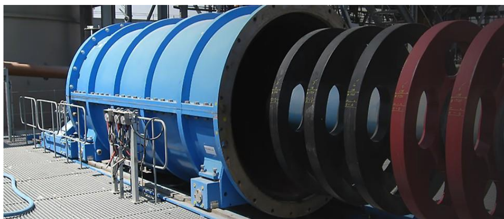
5 сурет - Isamill көлденең орналасқан майда ұнтақтауға арналған атритті диірмені [7]
